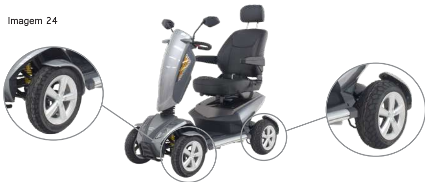
a) Detalhe das fixações das rodas dianteira (esquerda) e traseira (direita)
