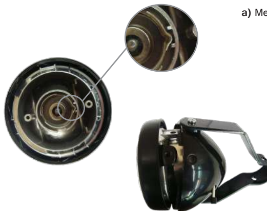
a) Detalhe do posicionamento da lâmpada e fechamento do farolete
