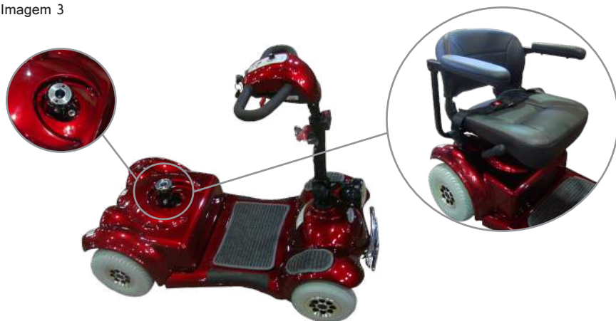
a) Mecanismo de remoção do banco
