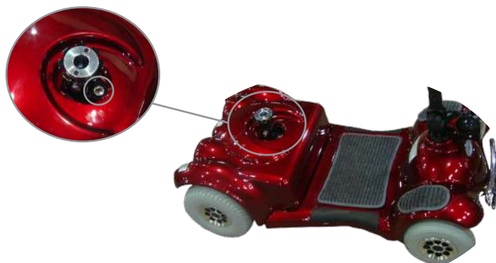
a) Disjuntor principal na Freedom Mirage SX e Freedom Mirage RX
