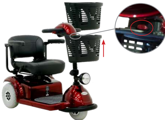
a) Mecanismo de remoção do cesto dianteiro
