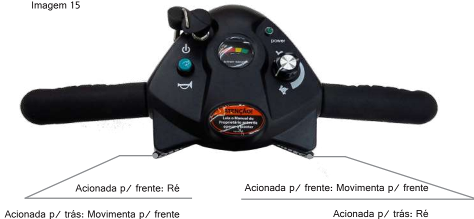
a) Funcionamento das gangorras da Freedom Mirage S
