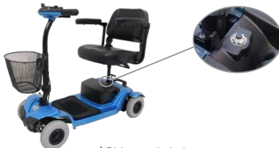
a) Disjuntor principal
